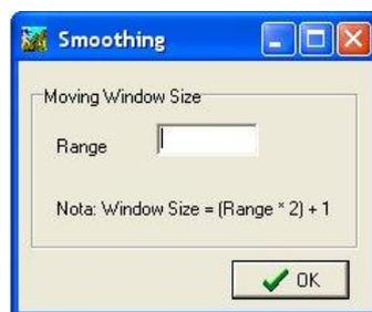
Figura 43. Definición del rango de la ventana utilizada para suavizar el MDE.
