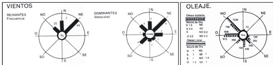
Figura 3. Frecuencia de los vientos dominantes. Dirección y altura del oleaje distante y local (Puertos Mexicanos, 1991).
